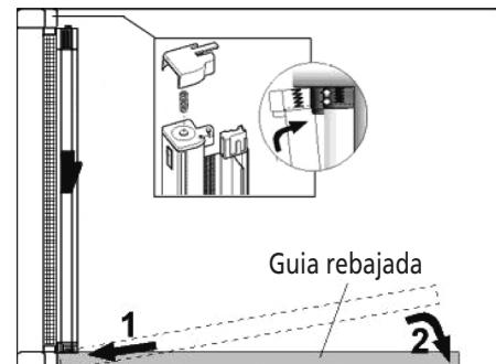
2 b: Introducir uno de los lados de la guía superior en el cajón registro izquierdo y en el otro lado posicionar el contratapon del cajón registro del lado derecho.
