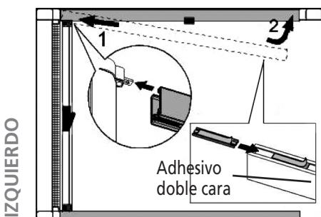
2 c: Introducir el cajón-registro derecho (DX) en el lado derecho y posicionar la mosquitera en el lugar deseado. Bloquear la mosquitera de modo definitivo mediante una llave allen e insertar los tapones T
